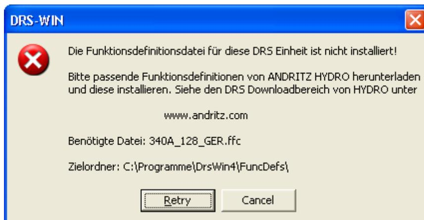
Bei der Parametrierung der Sammelschienenschutz-Zentrale (offline oder online) meldet unter Umständen das Bedienprogramm DRS-WIN das Fehlen von Basisdaten in der Art wie im unten gezeigten Fenster.
