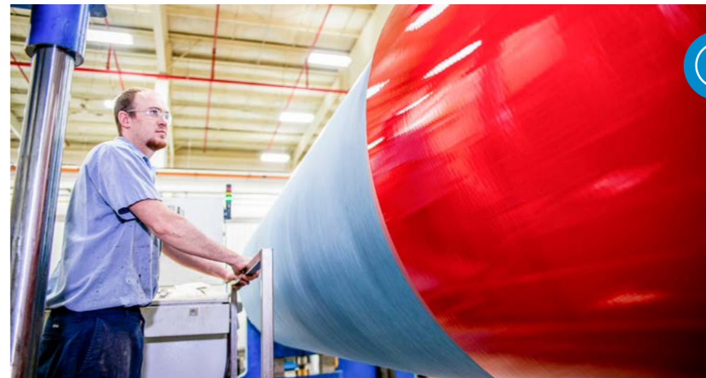
聚氨酯覆层的旋转浇注
