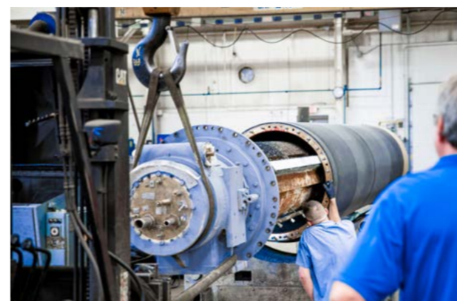
从真空辊上拆下吸水箱
