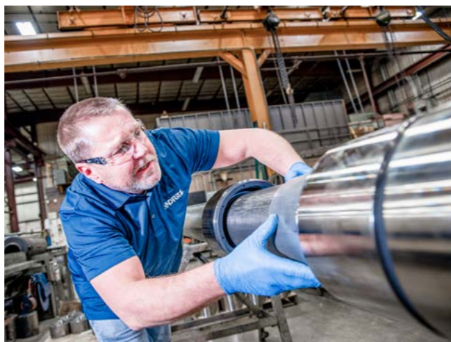
辊组件装配过程中的金属面弧形辊
