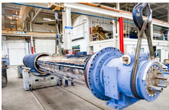
从真空辊上拆下的真空箱
