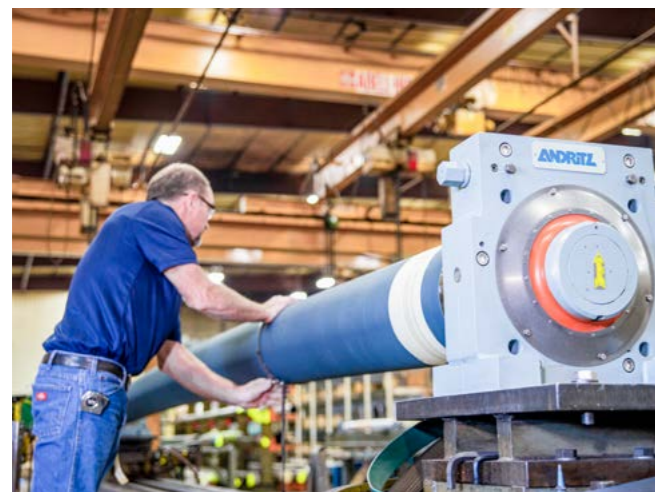
在测试台高速运转测试的完工弧形辊
