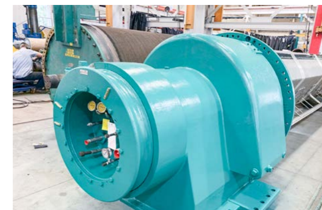
检修后的吸水箱
