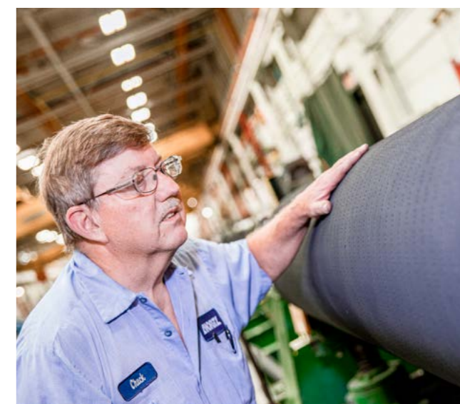
操作工检查开孔质量
