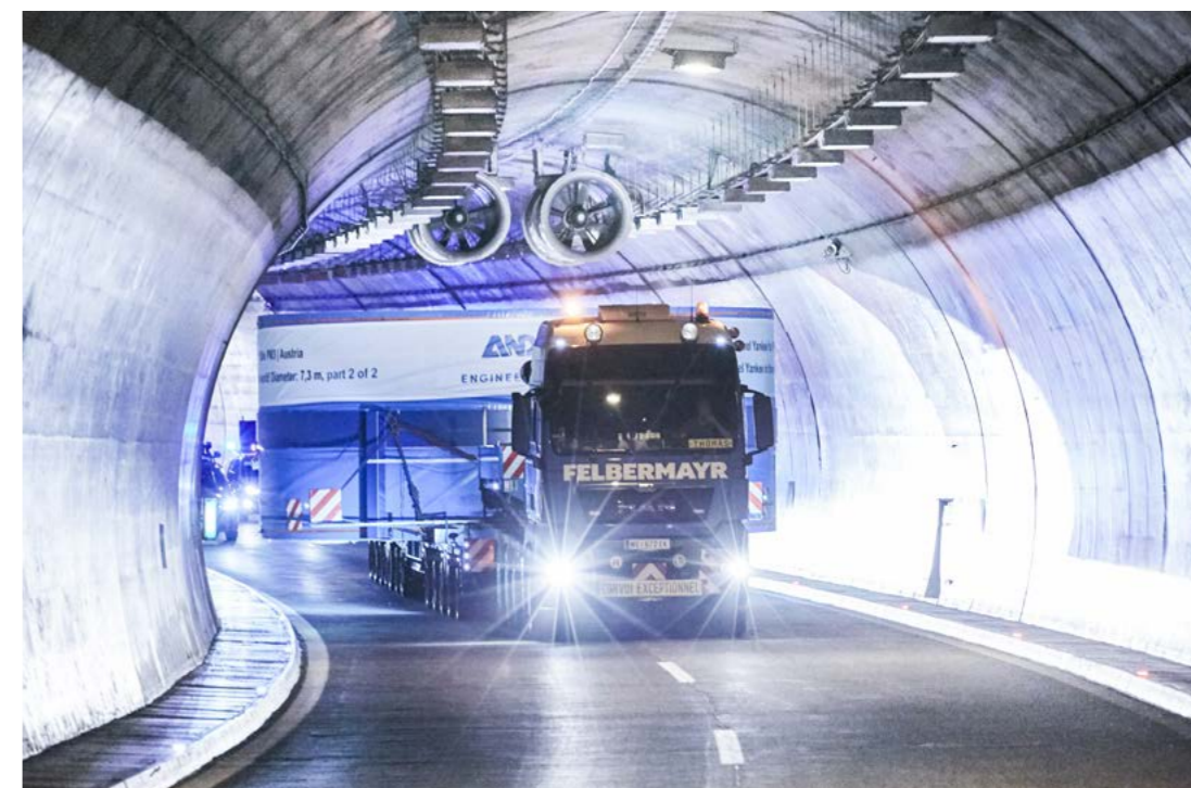
基于独特的安德里茨工程和专家物流概念，扬克缸被分两半运输，并在现场组装。
